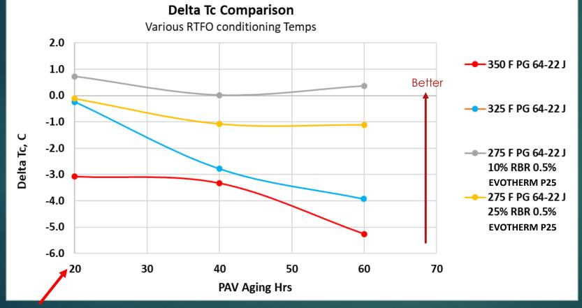
Delta Tc =  $T_{cont} S - T_{con} t$ m
